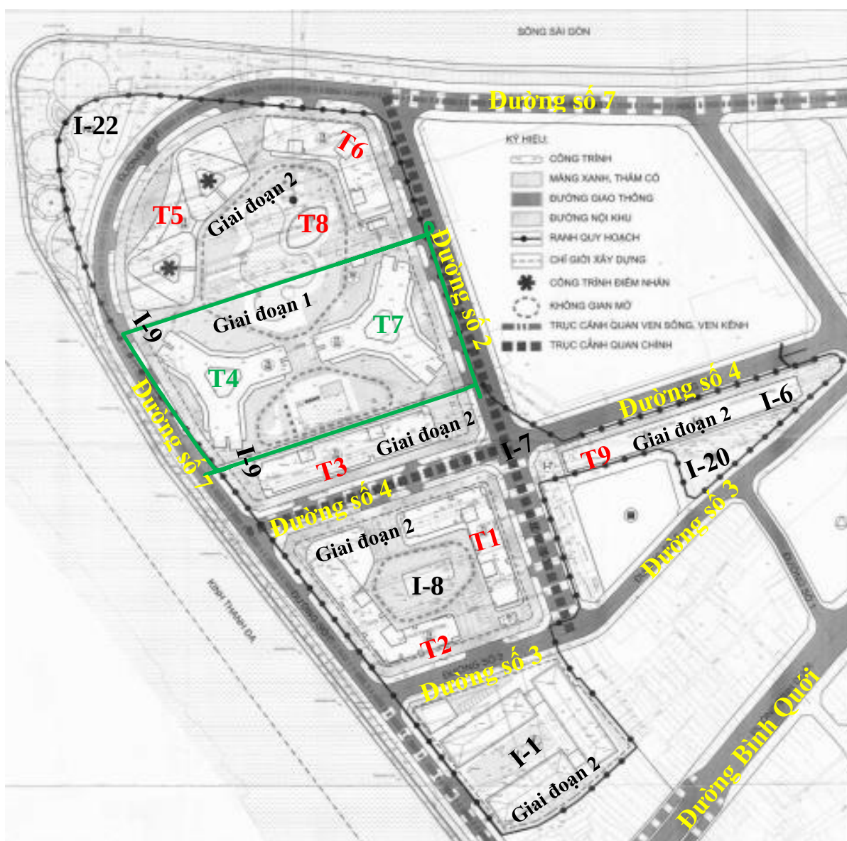
Hình 1. 10. Giai đoạn xây dựng các hạng mục công trình của dự án
