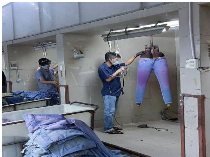
Hình 1. 19 Công đoạn phủ bề mặt
