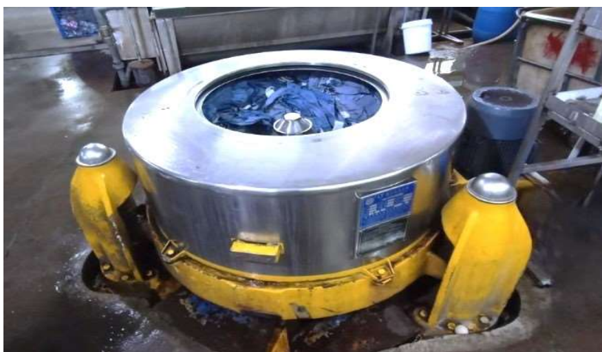
Hình 1. 18 Công đoạn vắt ly tâm
