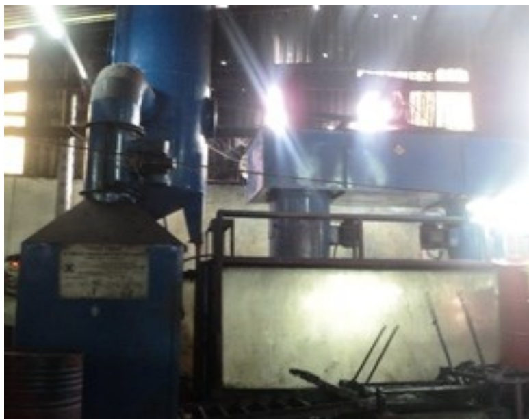
Hình 3.5 Hệ thống thu hồi cặn sơn và xử lý khí thải
