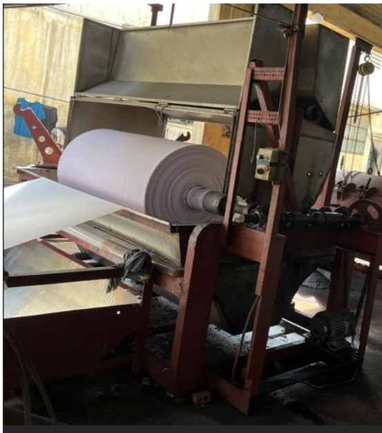
Máy tẩy – nhuộm hạ áp
